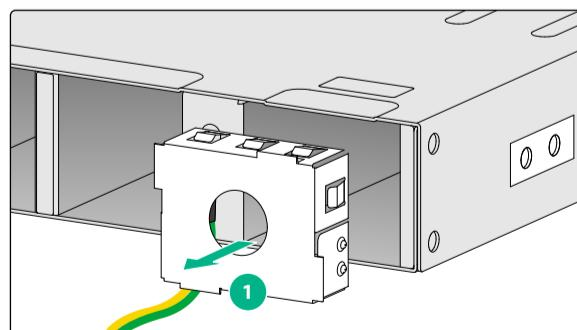
拆卸电源假面板，将拆卸下来的假面板放在左侧的槽位。
