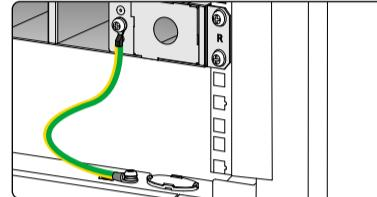
如果设备安装在机柜，可以将保护地线连接到机柜接地螺钉。
