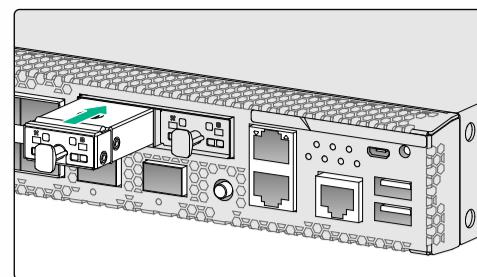
将硬盘沿着插槽导轨水平缓慢的推进插槽，直至硬盘完全进入插槽。
