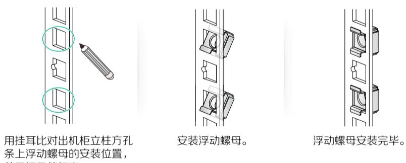
用挂耳比对出机柜立柱方孔条上浮动螺母的安装位置，并用记号笔标出。
