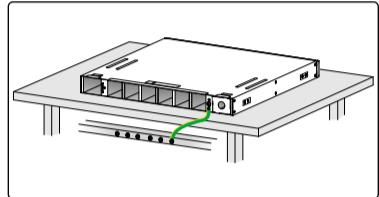
如果设备的安装工作台有接地排，接地线的另一端直接连接到接地排上。
